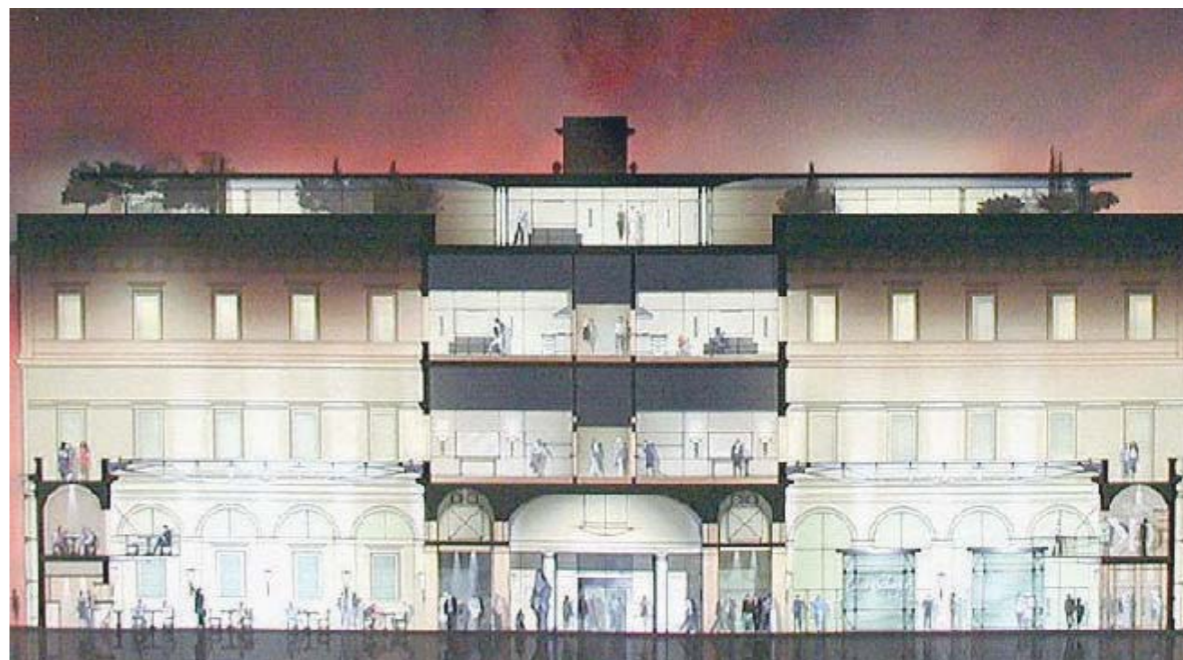
Nell'ultima versione dei disegni è possibile apprezzare sul fronte di corso Italia (a sinistra) l'abbassamento della copertura in vetro sulla facciata. A destra una sezione dell'edificio con le funzioni distinte (dal basso in alto) in negozi, uffici e residenziale. In basso la facciata su piazza Giulio, con i nuovi volumi arretrati sulla facciata
