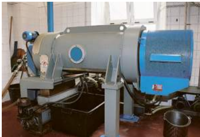
L'impianto continuo per la produzione dell'olio utilizzato al frantoio di Celle
