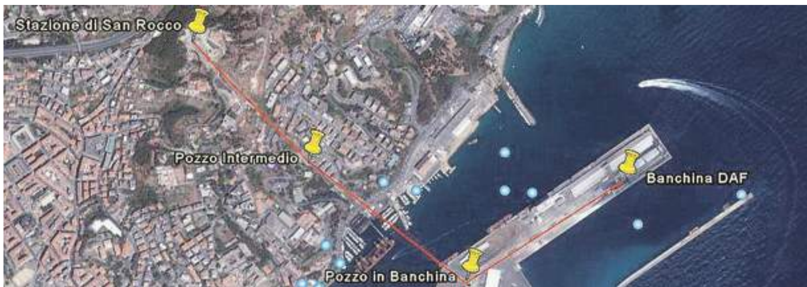
La linea rossa indica il tracciato del tunnel sotterraneo: dalla stazione San Rocco il carbone proseguirà sui vagonetti tradizionali
